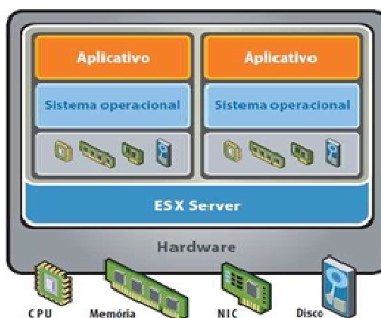
FIGURA 12 – Estrutura VmWare Esx Server Fonte: OLIVEIRA (2004)
