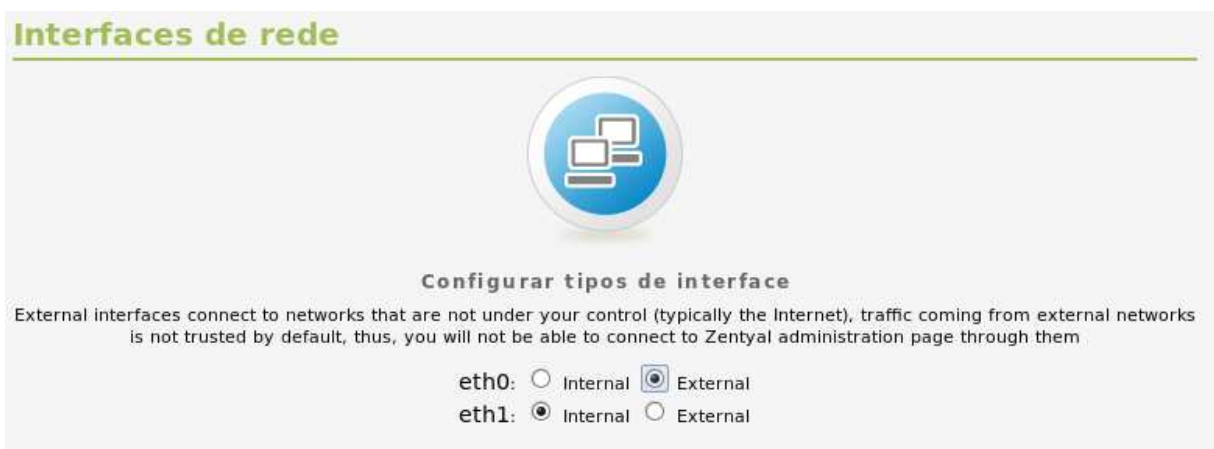
Figura 2 – Configuração de placas de rede do servidor.
