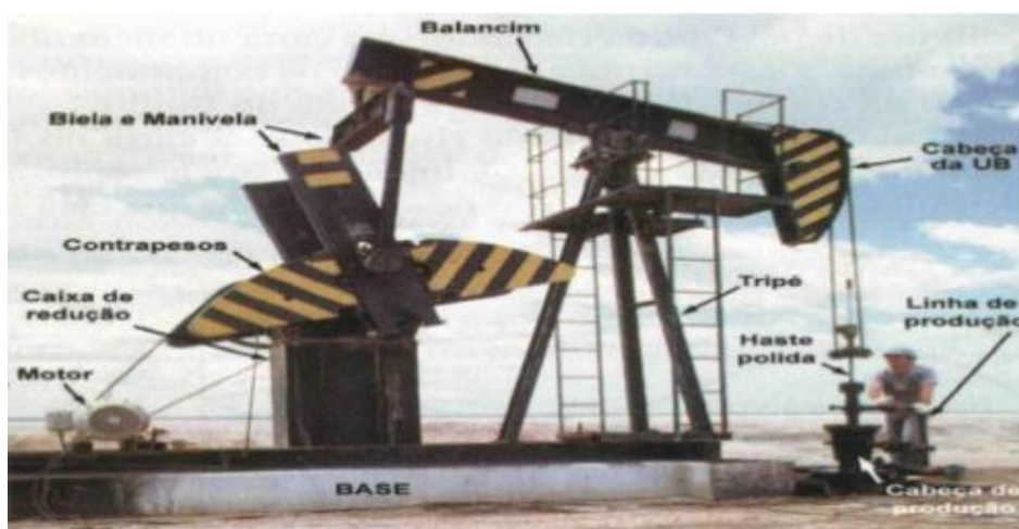
Figura 2: Unidade de Bombeio Mecânico.
