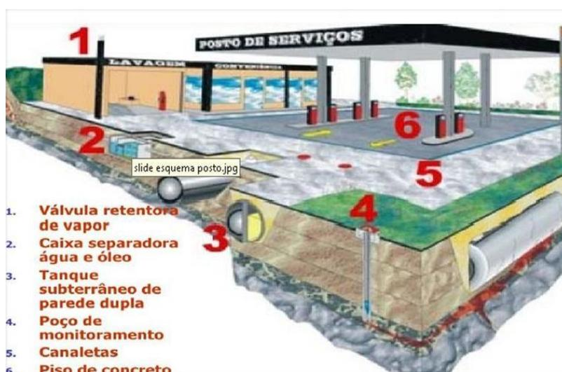
Figura 01 - Esquema Geral de um posto de combustível.
