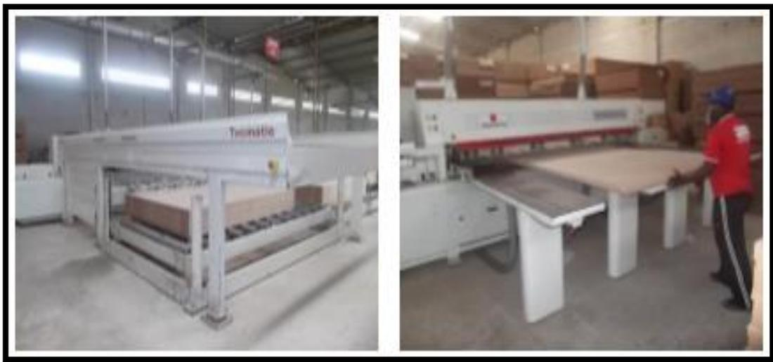
Figura 02 – Máquina seccionadora.
