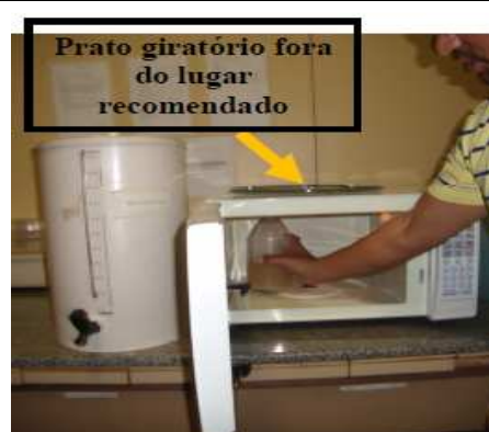
Foto 06. Após o forno aberto, empregado retira o prato giratório para que o frasco fechado entre na cavidade do equipamento e o coloca dentro do forno micro-ondas para aquecê-lo durante 4 minutos.
