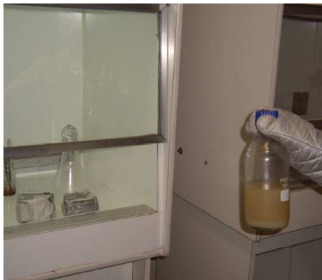
Fotos – 09 e 10. O empregado transportando o meio de cultura aquecido até a câmara de fluxo laminar, e antes de chegar à câmara o vasilhame e/ou frasco explode.
