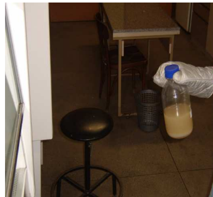
Fotos – 09 e 10. O empregado transportando o meio de cultura aquecido até a câmara de fluxo laminar, e antes de chegar à câmara o vasilhame e/ou frasco explode.
