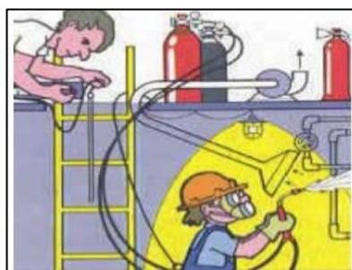
Figura 4 – Medição contínua da atmosfera.
