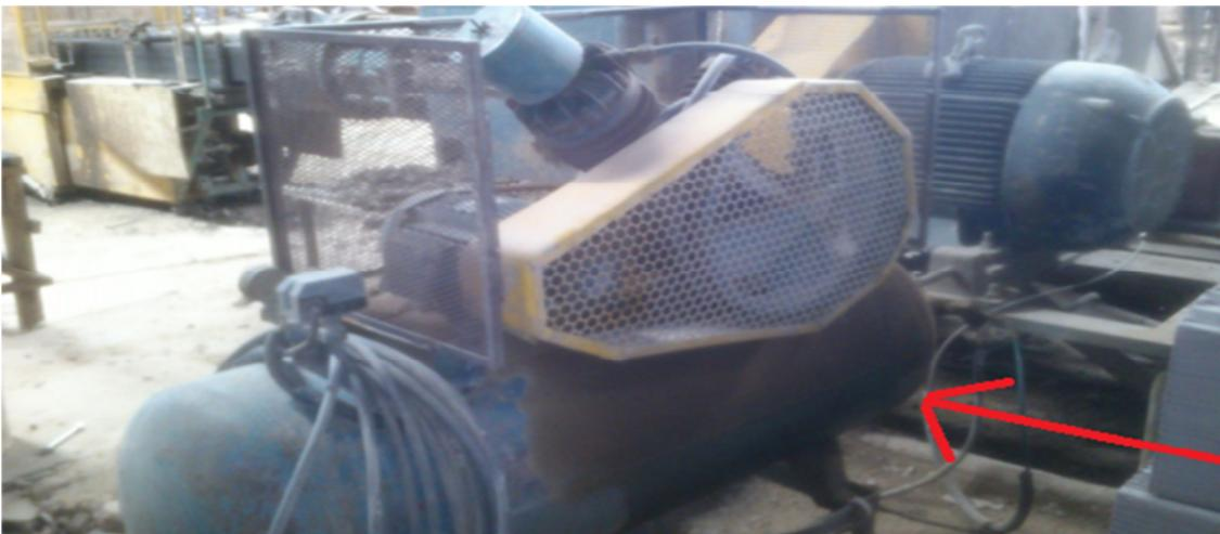
Figura 2 – Compressor apresentando problema (vazamento), perigosamente posicionado e sem a grade de proteção completa do equipamento.
