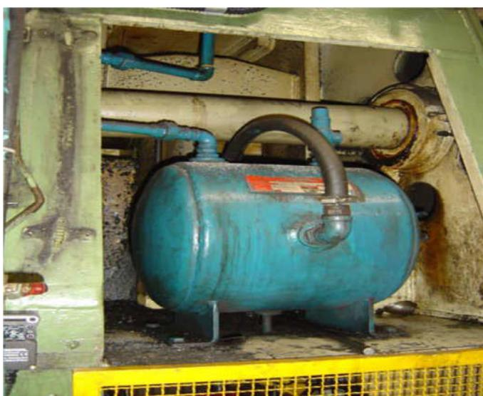
Figura 4 – compressor devidamente protegido e isolado.
