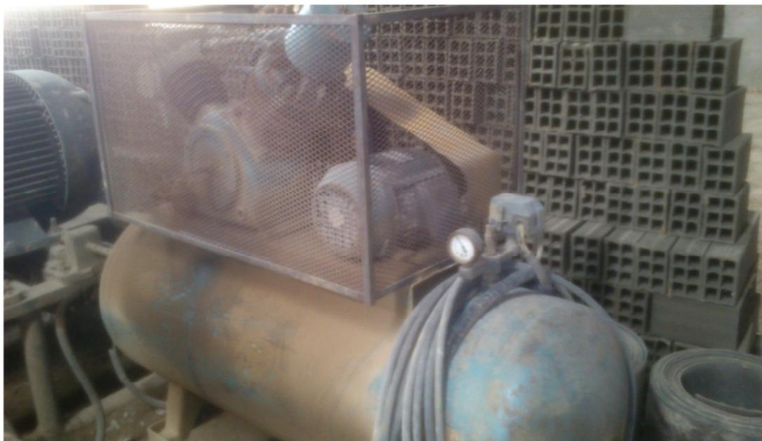
Figura 1 – Compressor alocado em local desprotegido e próximo a outros equipamentos.
