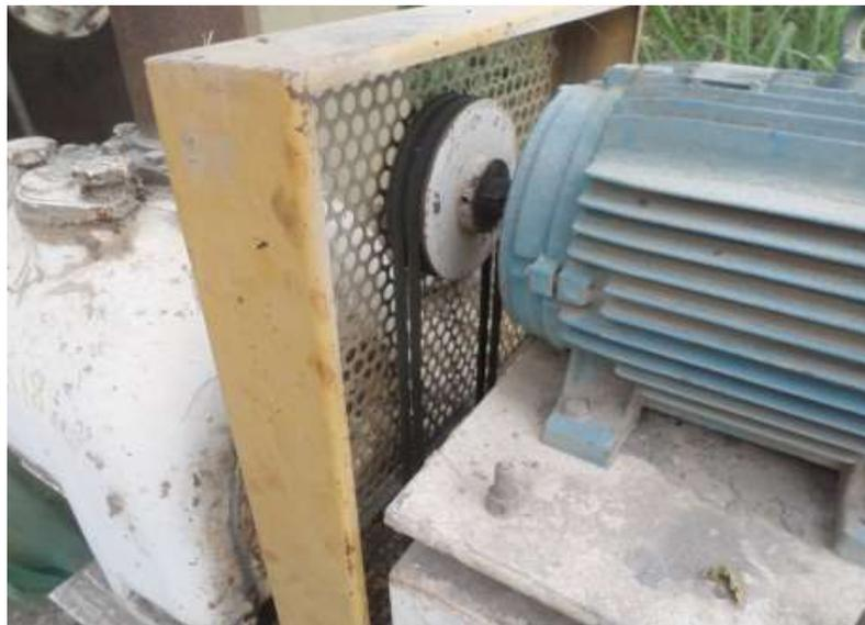
**Figura 02 – Proteção de maquina (Junho /2015)**
