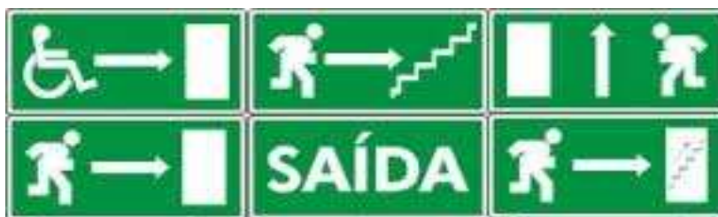
Figura 4. Sinalização de Orientação e Salvamento.
