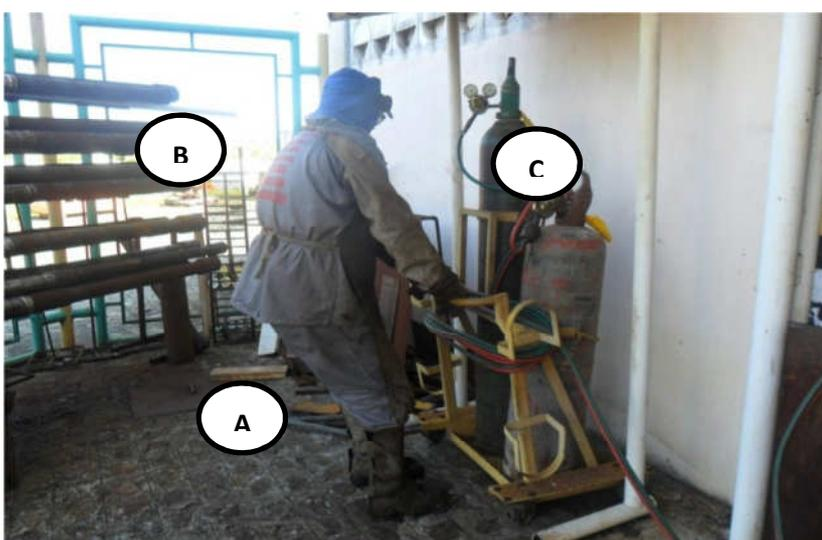
Figura 3 – Colaborador puxando carrinho de transporte de cilindro
