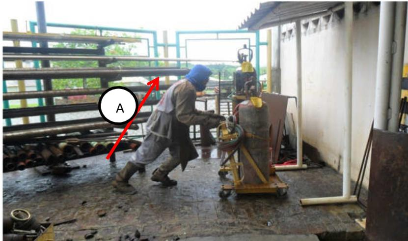
Figura 4 – Colaborador empurrando carrinho de transporte de cilindro
