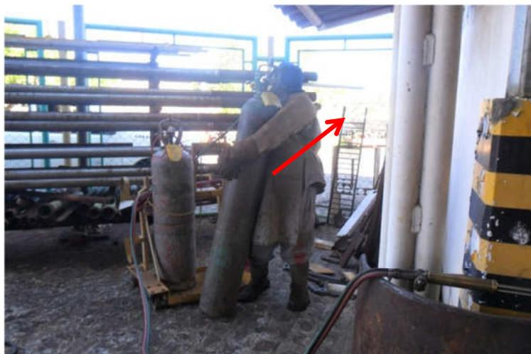
Figura 2 – Sobrecarga dos membros superiores na montagem do oxiacetileno
