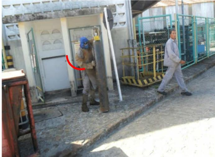
Figura 1 – Esforço para montagem de oxiacetileno
