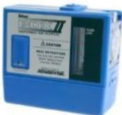
**Figura 1: Bomba programável de amostragem de poeira, marca Instrutemp**
