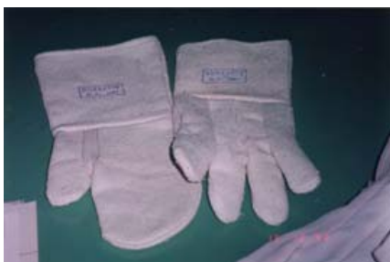
Figura 3: Luvas de amianto (EPs para manuseio de superfícies quentes).
