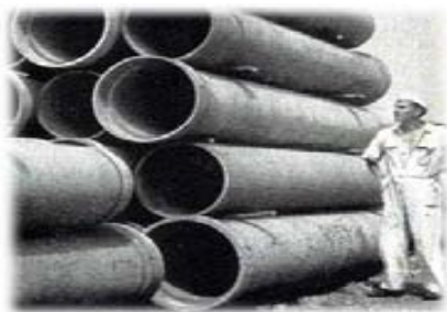
Figura 1: Tubulação de cimento-amianto.
