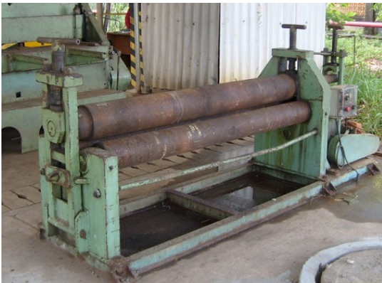
Figura 7: Calandra de Rolos antes
