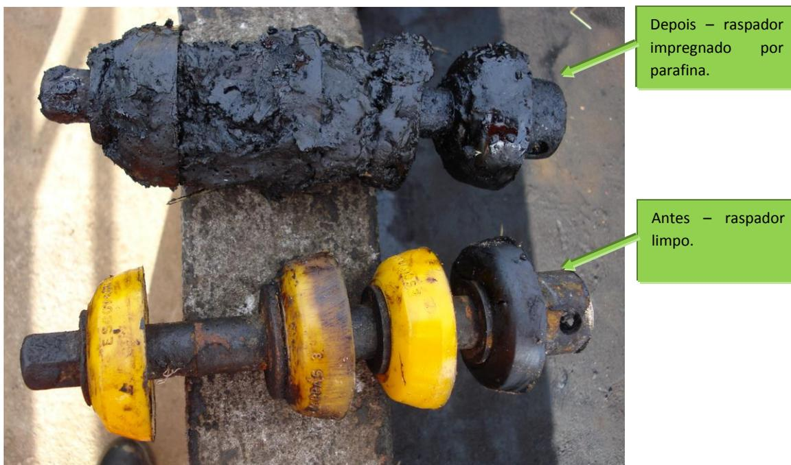
**Figura 01:** Comparação entre raspadores - antes e após a passagem na linha.
