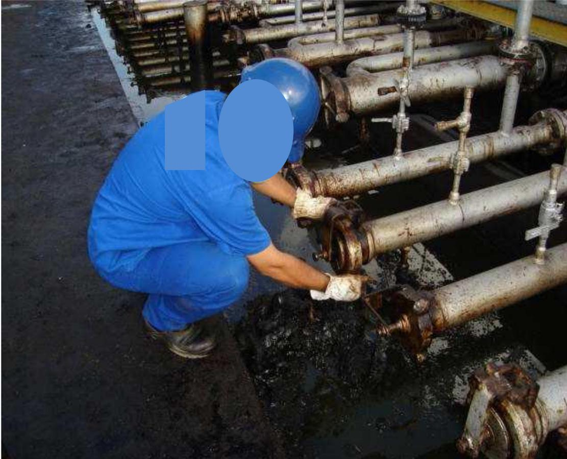
**Figura 05.** Postura do operador fechando o tampão da câmara de raspador.
