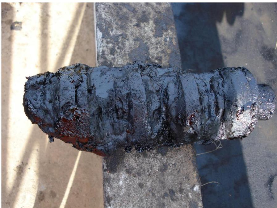
**Figura 02:** raspador totalmente impregnado por parafina.
