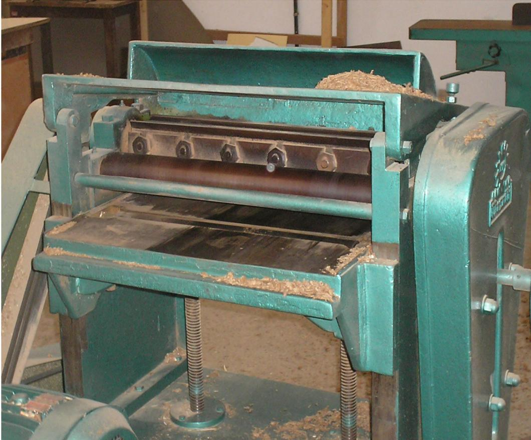
**Figura 10:** Foto do equipamento desengrossadeira, realizada pela minha autoria.
