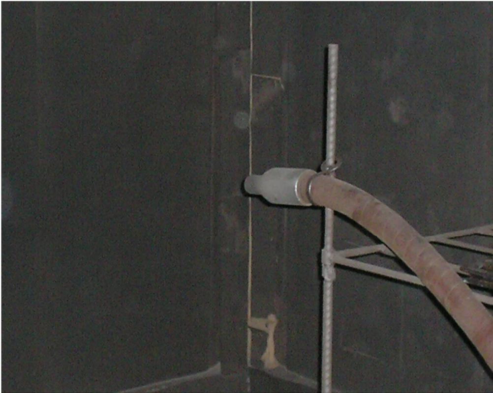
**Figura 3:** Foto do equipamento bico de jato, realizada pela minha autoria.
