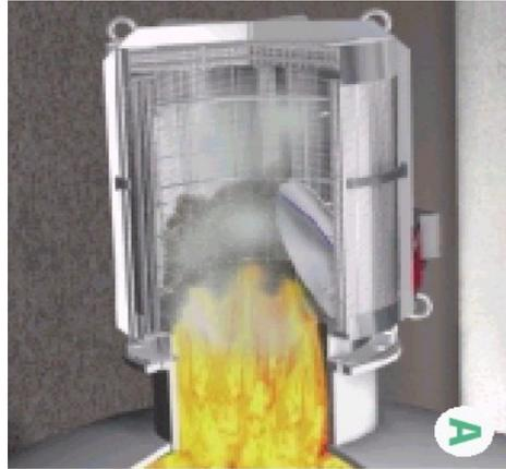
Figura 3. Dispositivo de Alívio de Pressão Q-box e Q-roth.
