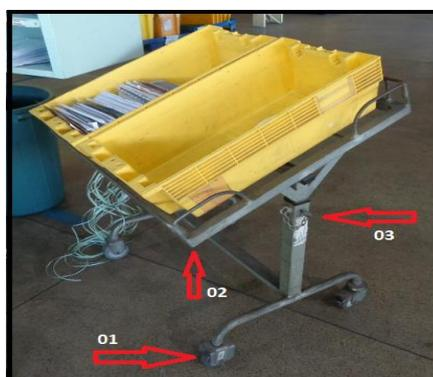
Fig.04 - Suporte de Caixetas - 01-rodas, 02-suporte com angulação, 03-manivela de ajuste
