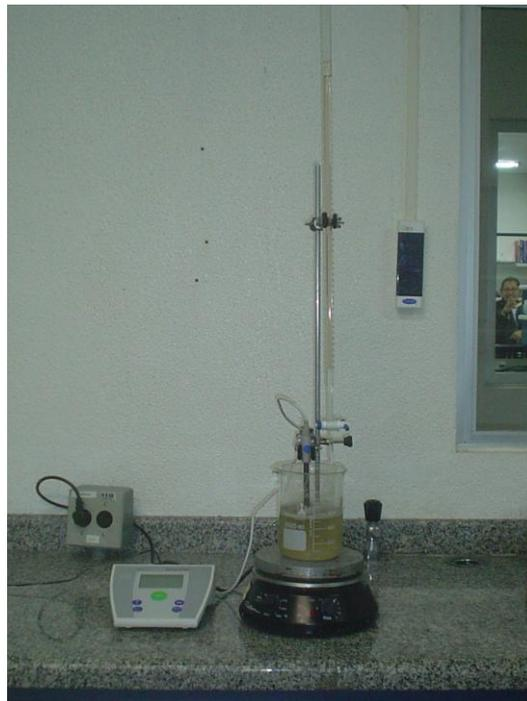
**Figura 4:** Sistema para calibração do condutivímetro com águas produzidas.
