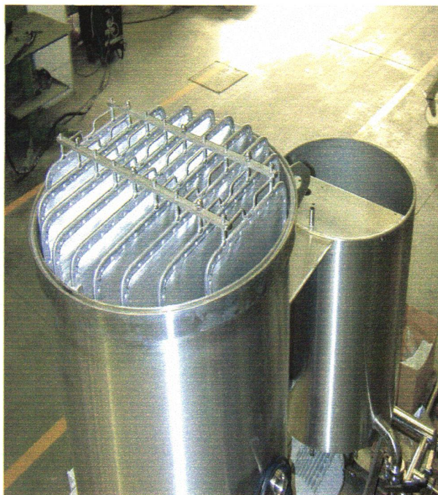
Figura 3 - Filtro de xarope simples de placas verticais (AMBEV, 2004)
