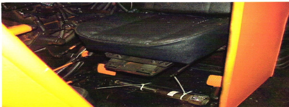
Figura 18 – Representa o pedal do acelerador, interligado por uma haste. Fonte CVRD.
