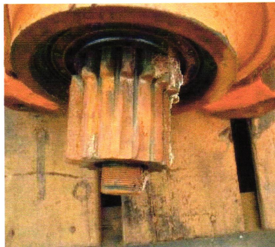
Figura 08 - Representação do pinhão quebrado no eixo do motor de tração. Fonte: CVRD
