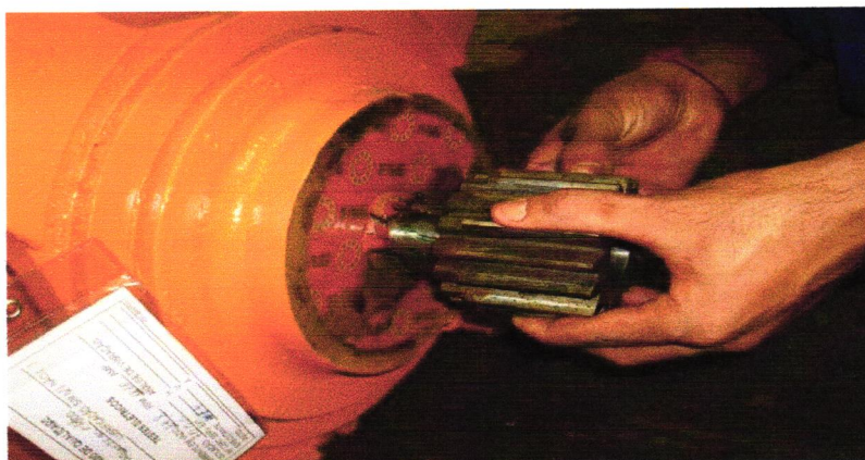
Figura 09 - Montagem do pinhão e chave no eixo do motor de tração. Fonte: CVRD
