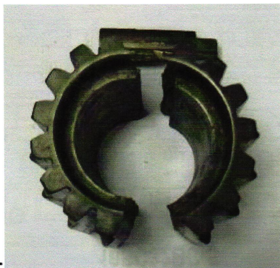
Figura 07 - Representação do pinhão quebrado. Fonte: CVRD
