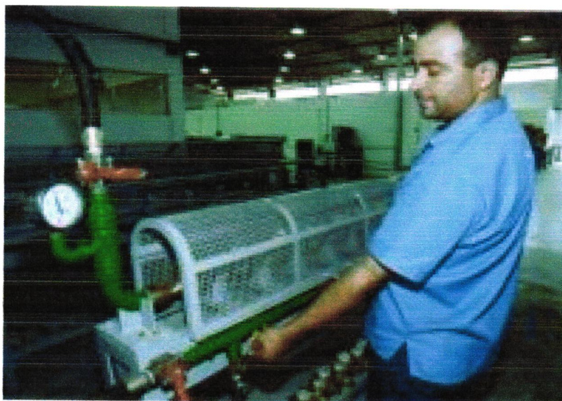
Figura 09: Calibração de hidrômetros Fonte: Companhia de Saneamento da Capital.
