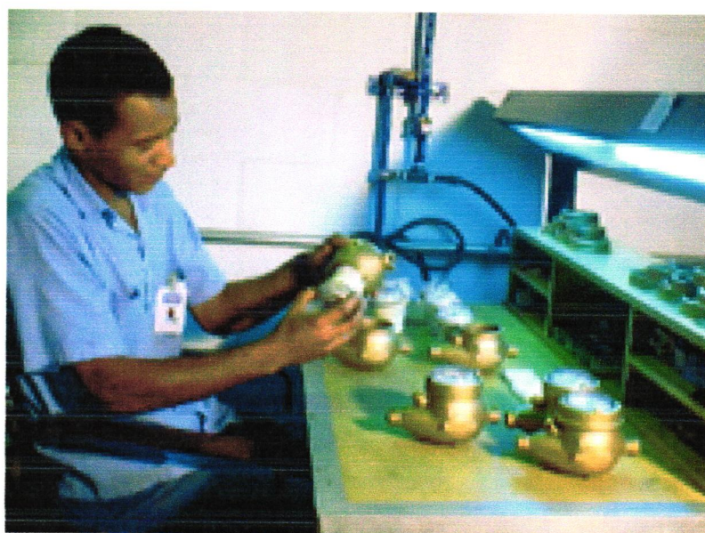
Figura 08: Montagem do dispositivo de medição à carcaça de hidrômetros Fonte: Companhia de Saneamento da Capital,
