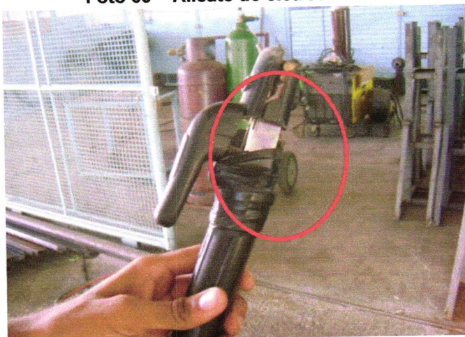
Foto 09 – Alicate de eletrodo danificado
