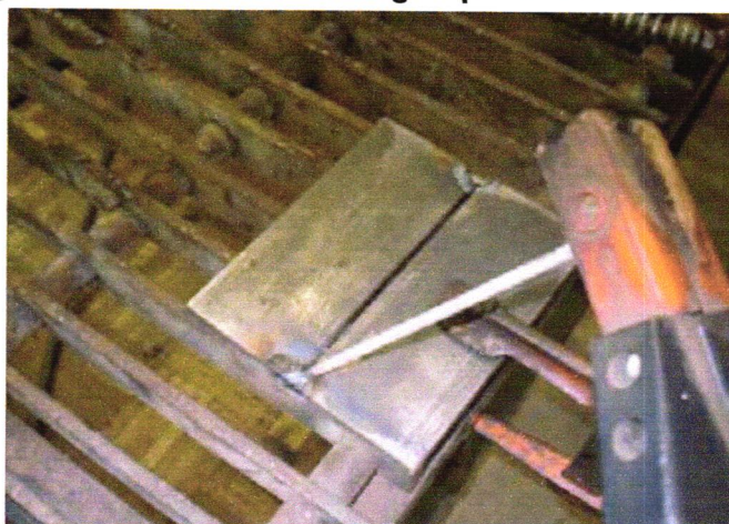
Figura 01 – Processo de soldagem por eletrodo revestido
