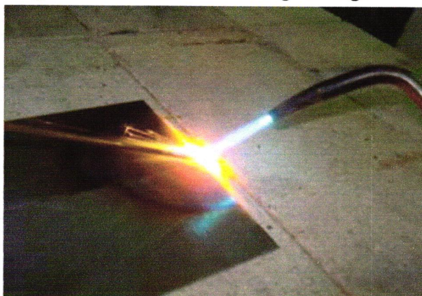
Figura 02 – Processo de soldagem oxigás
