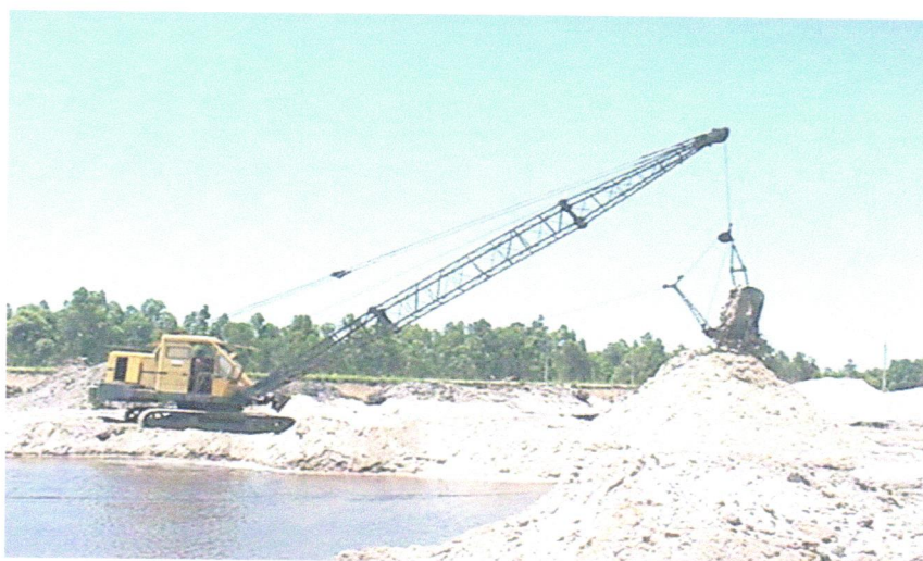
Figura 2 – Extração de areia com escavadeira equipada com Clam –Shell (Rio Acre/ AC)
