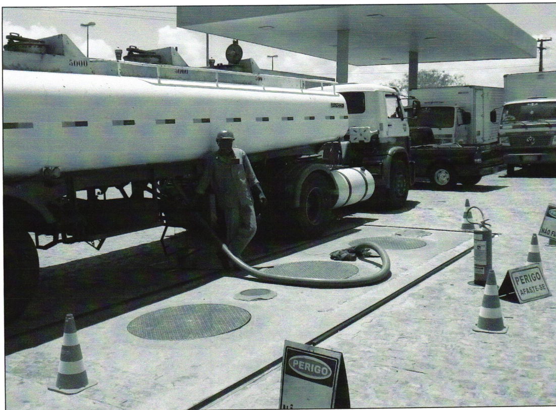
Figura 36 - Sinalização de segurança, aterramento e extintor durante o descarregamento de combustível.
