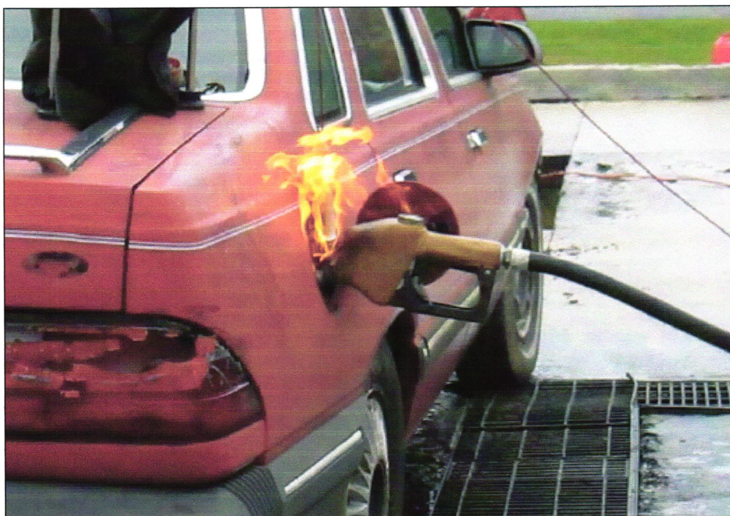
Figura 15 - Início de incêndio decorrente de descarga eletrostática.
