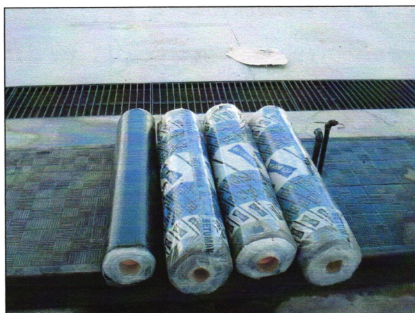
Figura 26 – Manta de PEAD para revestimento impermeabilizante do piso do posto.
