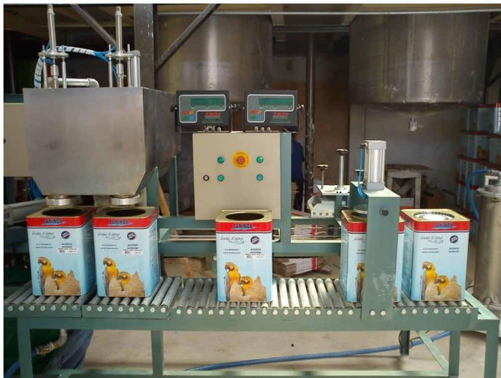
Figura 8. Processo de envase de tintas por batelada.
