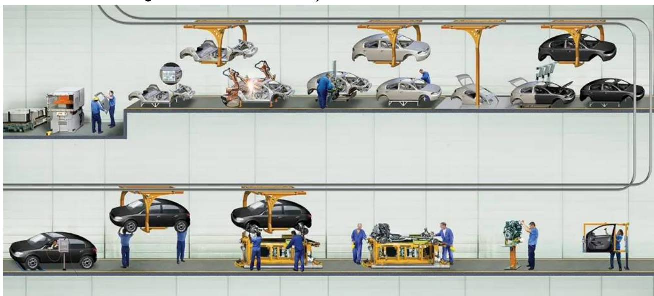
Figura 9. Processo de Produção em Linha de automóveis.
