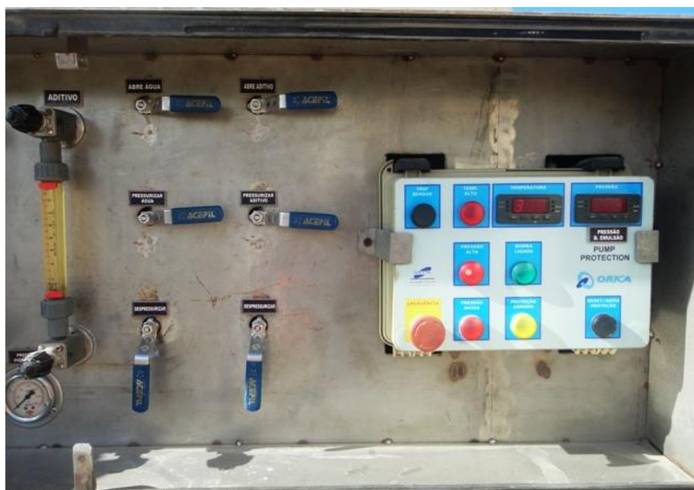
Figura 23 – Painel de caminhão de bombeamento
