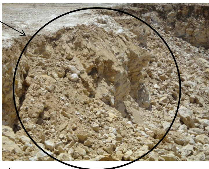
Figura 27 – Formação de fogo preso por vazamento de explosivo
