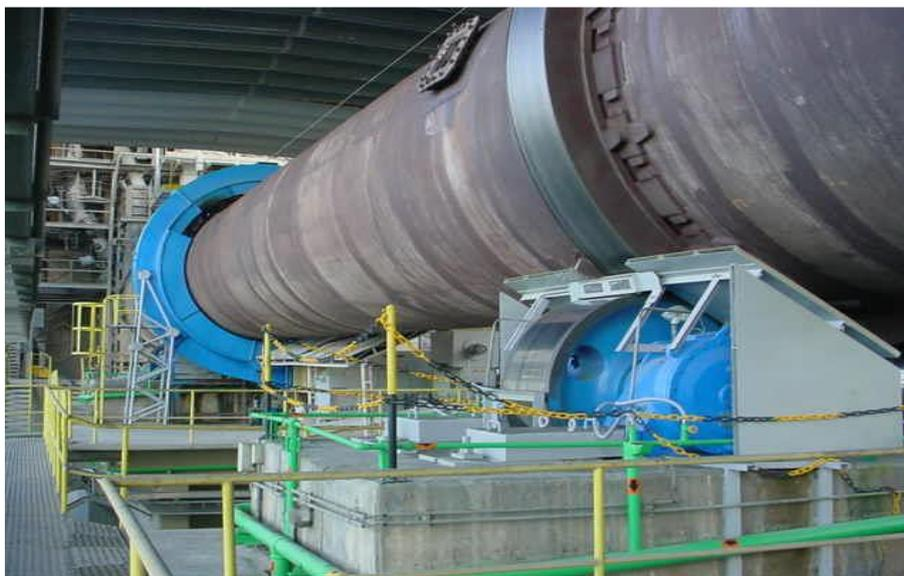
Figura 10 - Forno Rotativo (Fonte: CIMESA, 2003)
