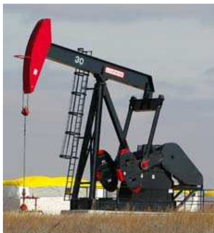
Figura 1 – Unidade de bombeio mecânico convencional
