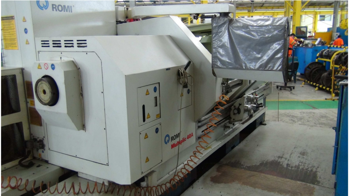
Figura 20 – Torno CNC ROMI Multiplic 40A
