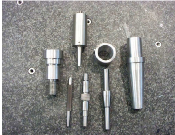
Figura 12 – Exemplos de componentes usinados em um torno
