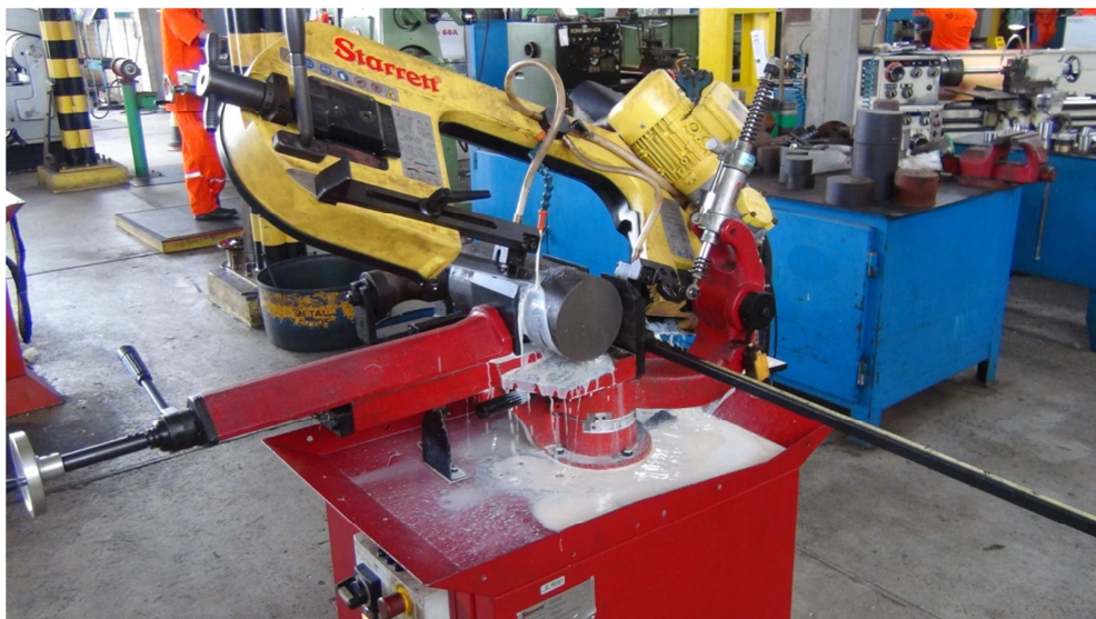
Figura 19 – Corte do tarugo na serra para a fabricação do sub-duplo
