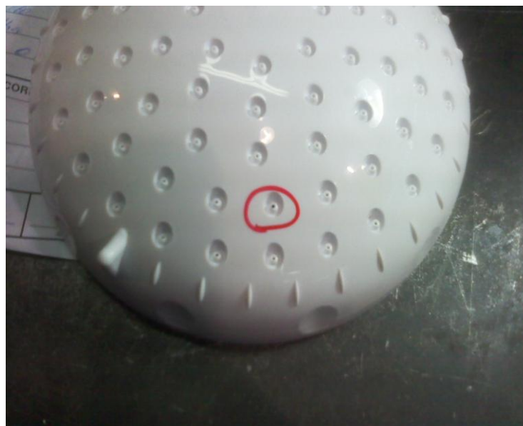
Figura 09: Produto com agulha quebrada
