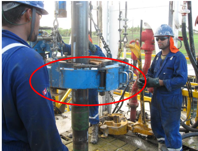
Figura 9 - Chave hidráulica posicionada no revestimento
