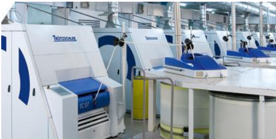
Figura 05 – Processo de cardagem
