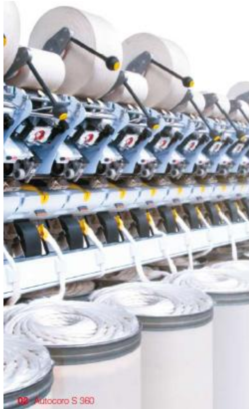
Fonte: (SCHLAFHORST, 2011) Figura 06 – Equipamento Open end's
