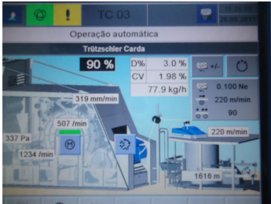
Fonte: Fiação Itabaiana Ltda Figura 18 – Definição de velocidade da Carda
