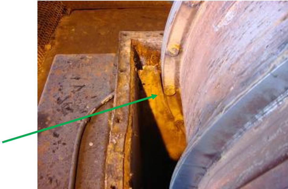
Figura 18 – Desgaste do anel de borracha na chapa defletora
