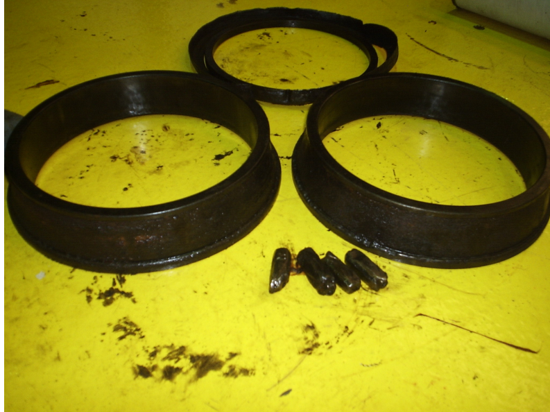
Foto 3 – Rolamento danificado do redutor
