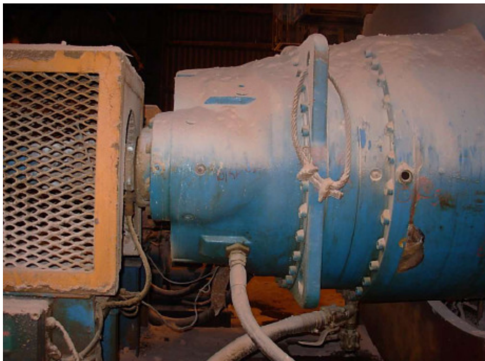
Foto 8 – Redutor planetário do compactador
