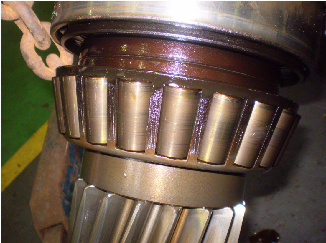
Foto 9 – Rolamento danificado do redutor planetário
