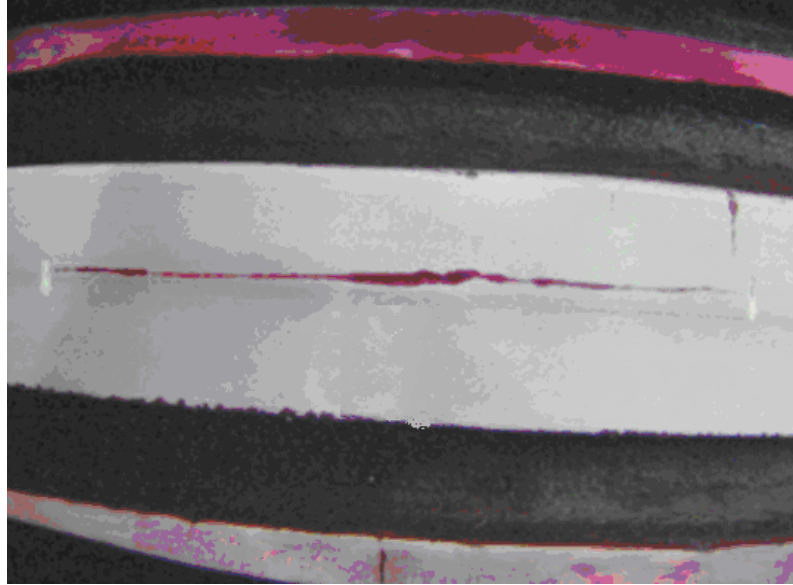
Foto 5 – Trinca nas regiões 6 e 7 no eixo.
