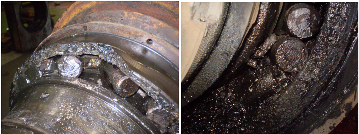
Foto 4 – Rolamento danificado do eixo.
