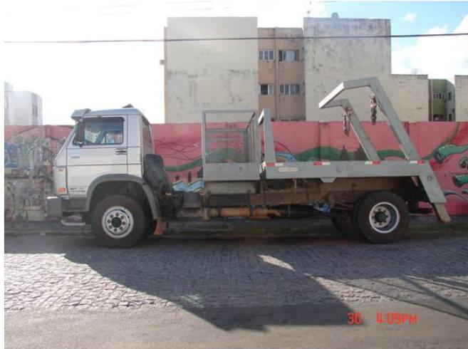
**Figura 02 – Caminhão tipo poliguindaste simples**
