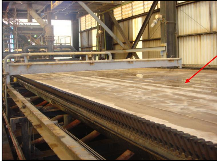
Foto 2: Evidência da aplicação da lama sobre o filtro
