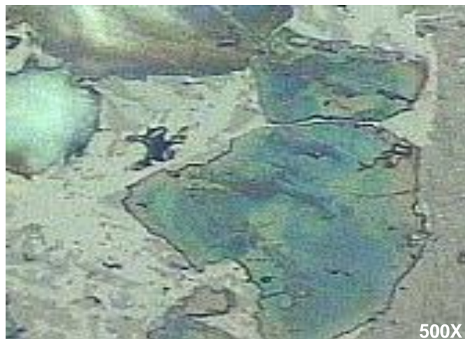
Figura 8 – Cristal de alita com bordas corroídas
