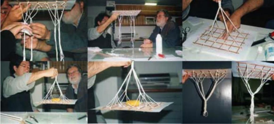
**Imagem 39** - Demonstração do processo para determinação das posições dos “ramos”
