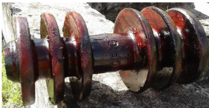
Figura 16 - PIG raspador monolítico, fabricado em poliuretano de alta resistência e flexibilidade, utilizado nos dutos LC-1 e LC-2
