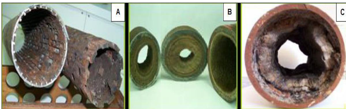
Figura 9 - Elementos do sistema de produção e transporte de petróleo com incrustação inorgânica
