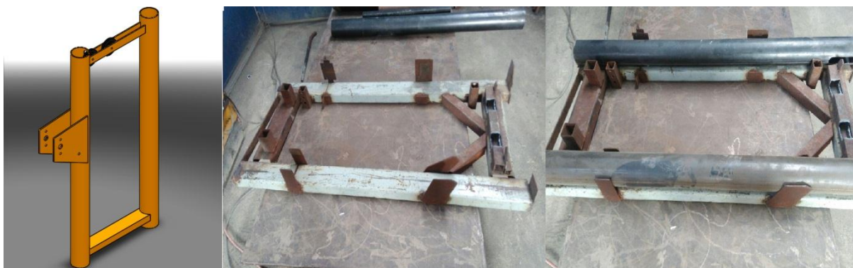
Figura 30 – Dispositivo poka-yoke para a montagem.
