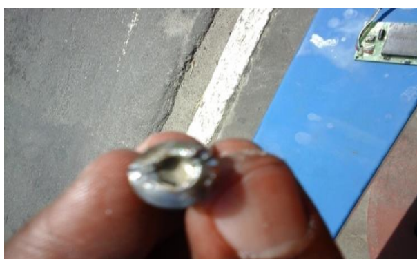
Figura 31 - Parafuso depredado devido ao ressecamento
