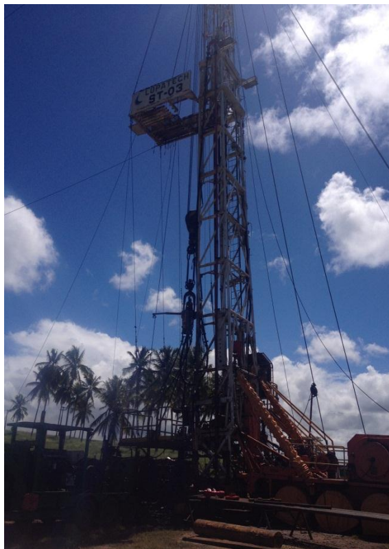
Figura 10 – Sonda de perfuração adaptada e um poço com uma UBM
