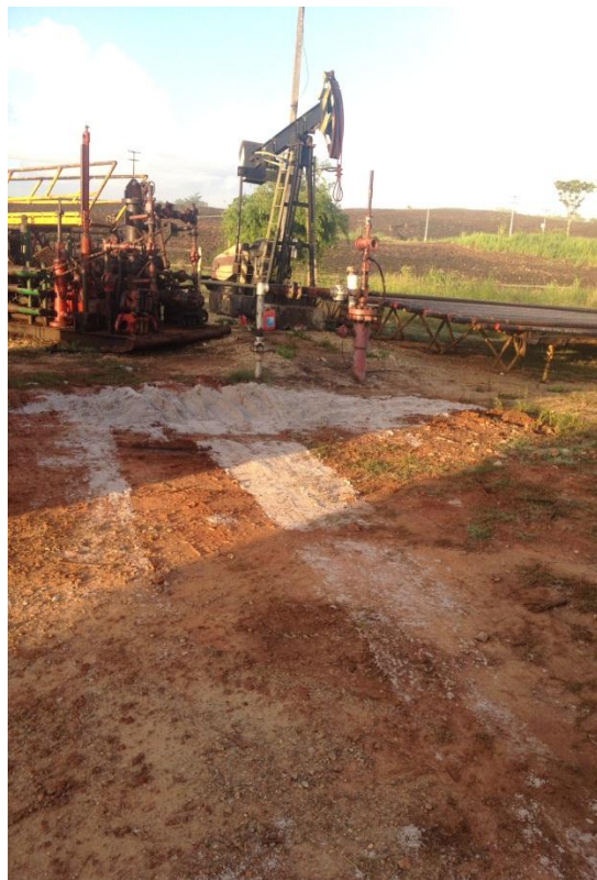
Figura 10 – Sonda de perfuração adaptada e um poço com uma UBM
