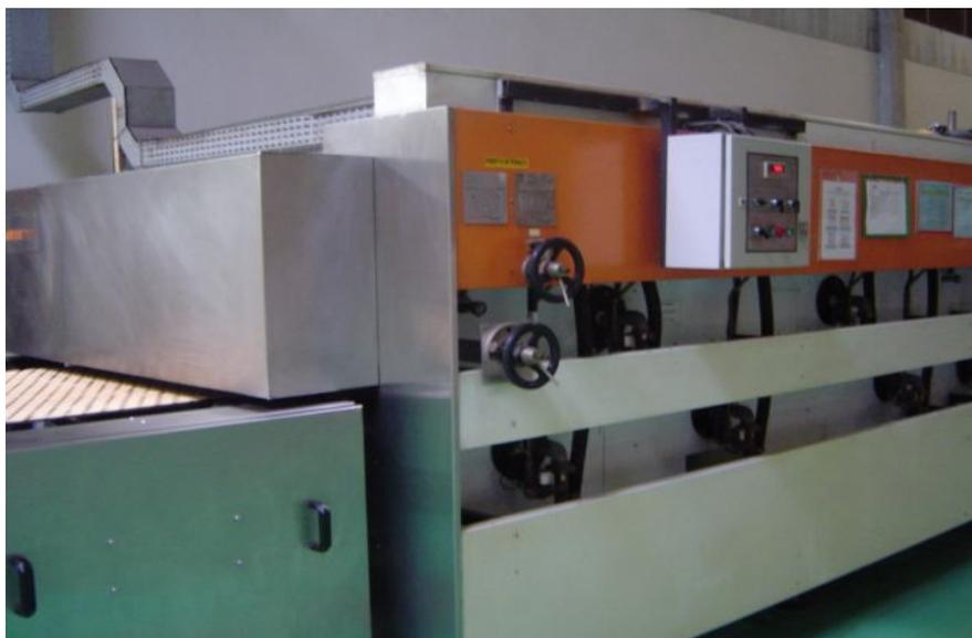
Figura 02 - Forno da linha de recheados
