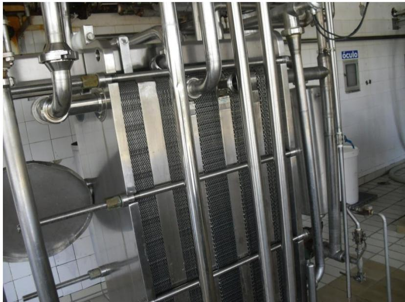
**Figura 8:** Chicana de refrigeração do “Padronizador”
