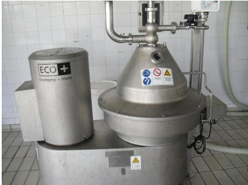
**Figura 9:** Centrífuga ligada ao “Padronizador”
