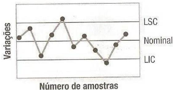
**Figura 4:** Processo com variável fora dos limites.
