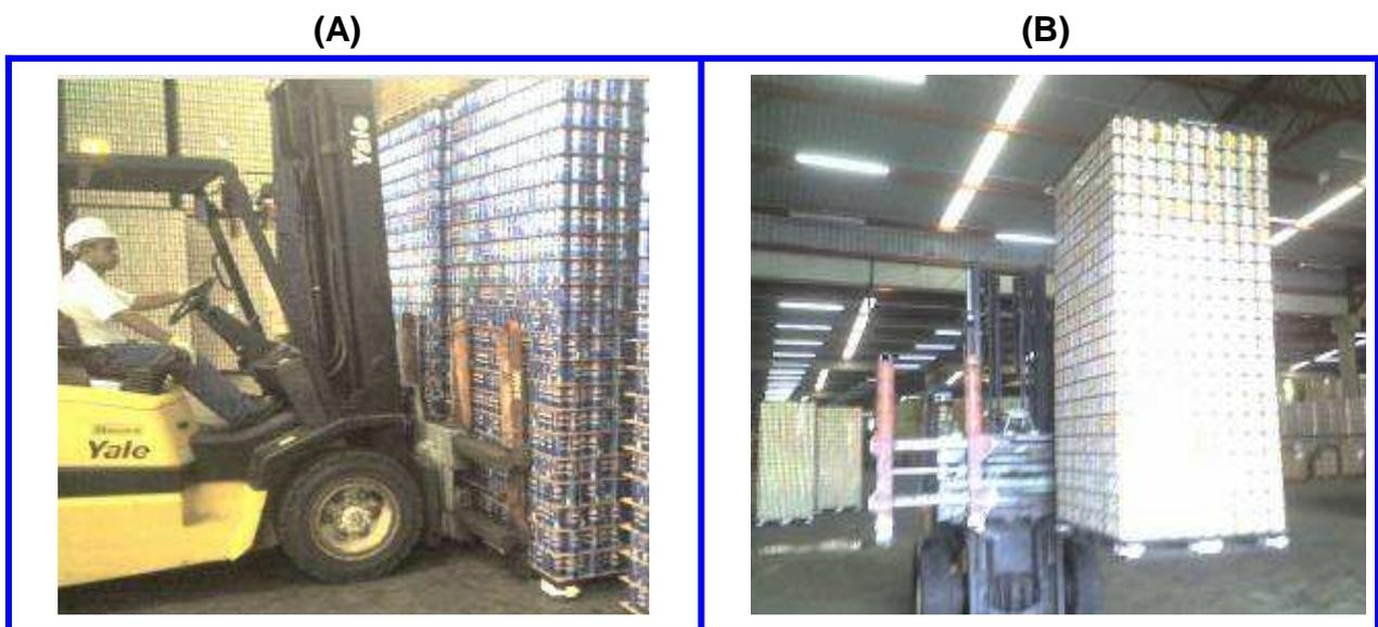
**Figura 5 - (A) Descarregamento de latas antes da melhoria, (B) Descarregamento de latas após a melhoria**
