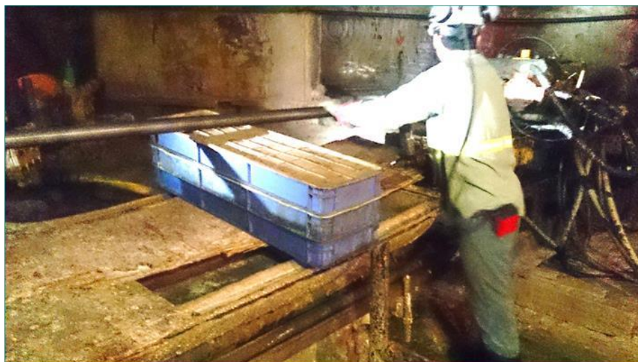
Figura 8 – Manobra de retirada de hastes
