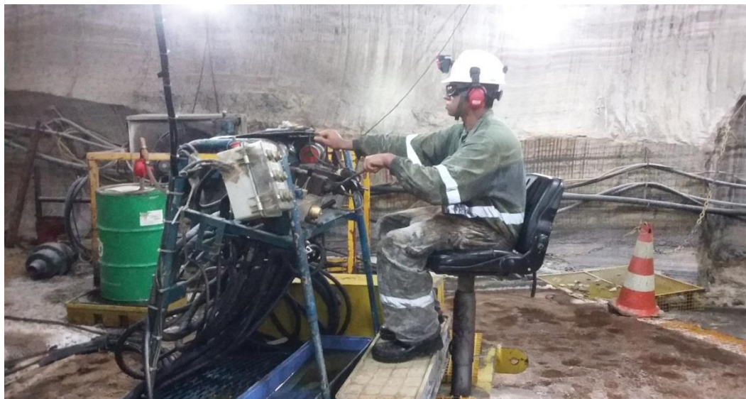
Figura 15 – Assento do operador antes da substituição
